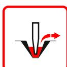
2. Хотя Система HILST гидрофобна, мы рекомендуем, чтобы стоячей воды в лунке не было. Для гарантии качественной реакции состава **A**, воду лучше откачать, либо добавить засыпку, чтобы вода не доходила до дна лунки. Добавляйте грунт, пока воды не будет видно или же откачивайте ее.
