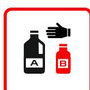
5. Каждый комплект содержит емкость с составом **A**, емкость с составом **B** и перчатки. Большая емкость состава (A) служит тарой для смешивания. Примечание: если для заливки лунки требуется несколько комплектов, расширение каждого следующего может идти быстрее из-за тепла, выделяемого предыдущим.
